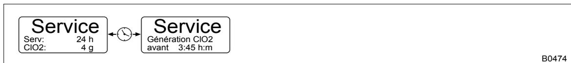
Fig. 14 : Affichage alterné « Service » (réglage standard)
