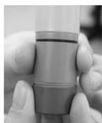
Avant un montage de la sonde dans la chambre de mesure, mettre le système hors pression.
