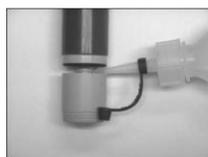
Desserrer la bague située en extrémité de la sonde. Ouvrir le flacon d'électrolyte, mettre la canule sur le haut du flacon et expulser l'air excédentaire. Appuyer ensuite sur le flacon d'électrolyte et expulser le lentement et sans faire de bulles d'air dans le réservoir. Retirer progressivement le flacon. Revisser la bague jusqu'au joint torique et serrer.
