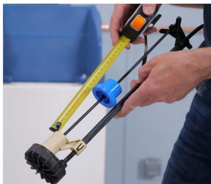
La cote «X» doit mesurer **45 mm**. Réglez-la si nécessaire en faisant coulisser le flotteur bleu sur la tige du régulateur puis replacez le régulateur dans le puits à saumure.
