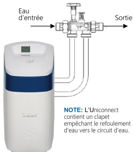
**NOTE:** L'Uniconnect contient un clapet empêchant le reflux d'eau vers le circuit d'eau.
