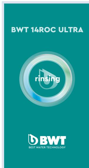
**DE:** Nach jeder Produktion wird die Membran für 10 s mit Eingangswasser gespült. Wenn keine Produktion stattfindet, wird die Anlage alle 3 Stunden mit Eingangswasser gespült.
