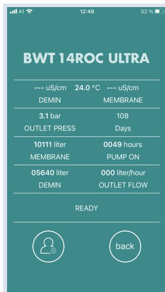
**DE:** Wenn Sie während des Betriebs den „working“-Knopf drücken, erscheinen folgende Betriebsdaten: Leitfähigkeit bestdemin Plus und bestqua 14ROC Membrane: Falls der Sollwert noch nicht erreicht ist, blinkt die Anzeige „ $\mu\text{S}/\text{cm}$  MEMBRANE“ und es wird kein Permeat produziert; Ausgangsdruck nach bestdemin Plus; Laufzeit seit Inbetriebnahme; Wasserzähler bestqua 14ROC Membrane und bestdemin Plus; Betriebsstunden Pumpe; Wasserzähler Ausgang
