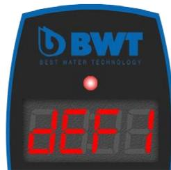
FIGURE 11 : Acquiescement de l'alarme de remplacement de la lampe
