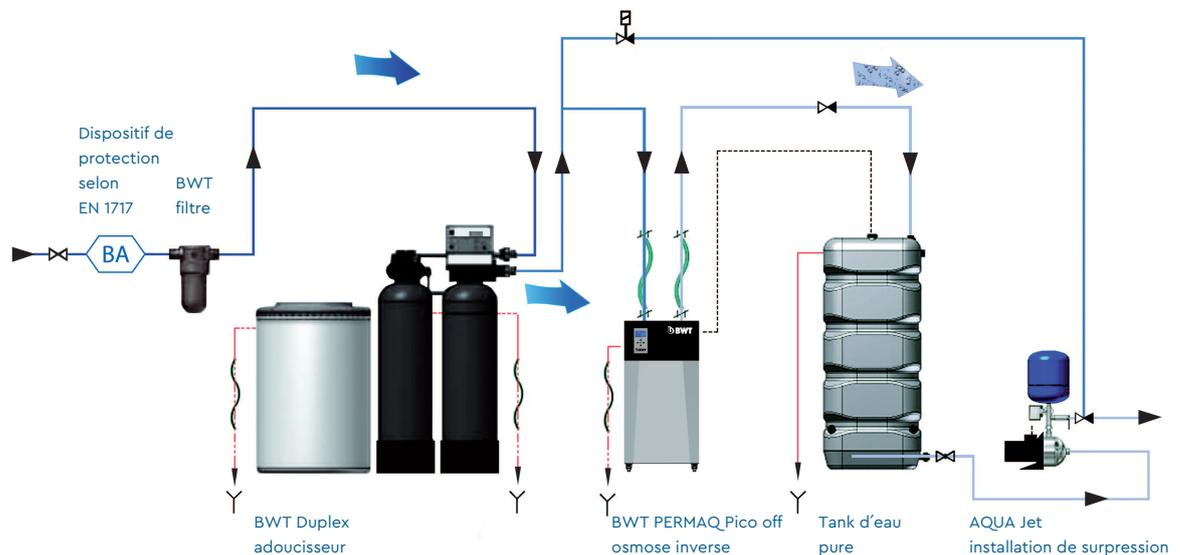
Fig. 11: exemple d'installation BWT PERMAQ® Pico Offline
