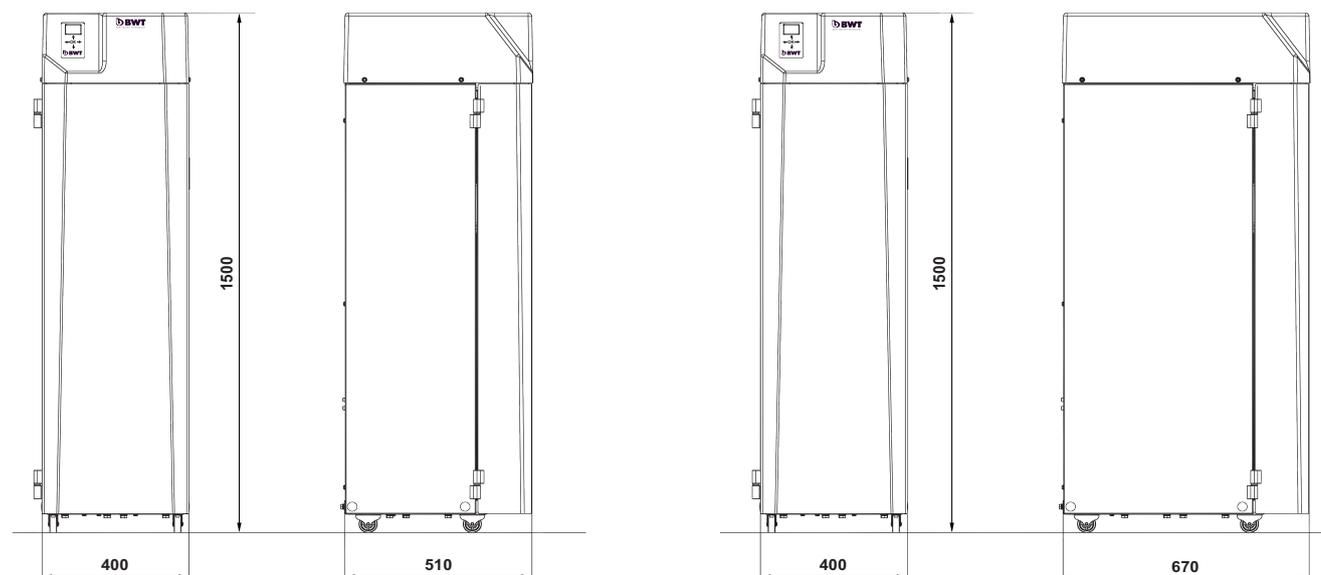
Fig. 30: dimensions Pico 40-70 (Pico 80-90 : voir chapitre Dimensions BWT PERMAQ® Pico 40-90 HR on/off [► 52])
