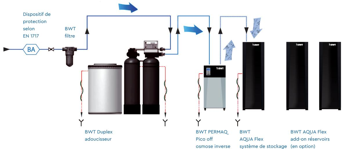
Fig. 12: exemple d'installation BWT PERMAQ® Pico Offline avec BWT AQUA Flex
