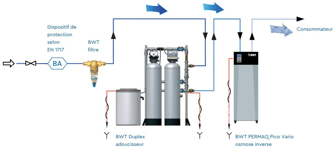
Fig. 14: exemple d'installation BWT PERMAQ® Pico Vario
