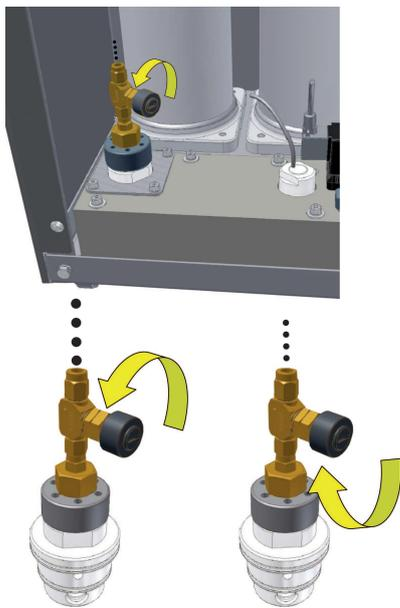
Fig. 26: vanne de réglage du concentrat
