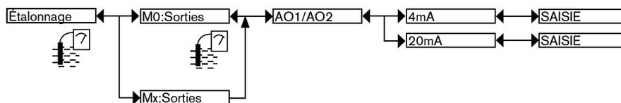
4mA : Ajuster l'offset de la sortie courant.
