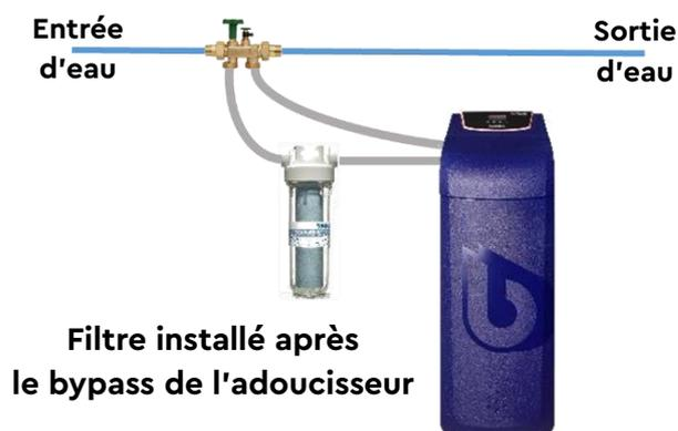
▶ Installez le bypass en laiton fourni avec l'adoucisseur. Ce bypass est indispensable pour isoler l'adoucisseur pour les opérations de maintenance, réaliser les tests de dureté et pouvoir fournir le logement en eau pendant les phases de régénération et en cas d'intervention sur l'appareil. Pour la configuration de droite ci-dessus ; il est impératif d'installer le flexible entre le filtre et la bride.
